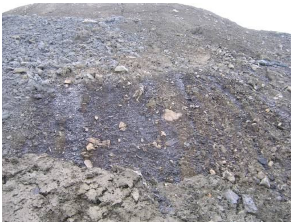
Foto 6: percolato uscente dal versante Nord della vasca numero 3
